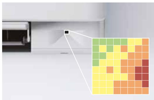
Intelligent Thermal Sensor misura la temperatura delle superfici della stanza dividendola in 64 diversi quadrati.
